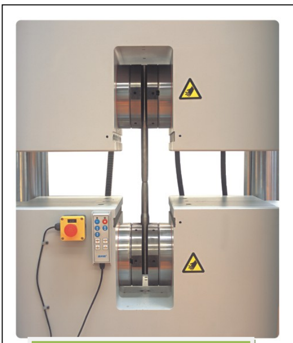
Steel rod tensile test
